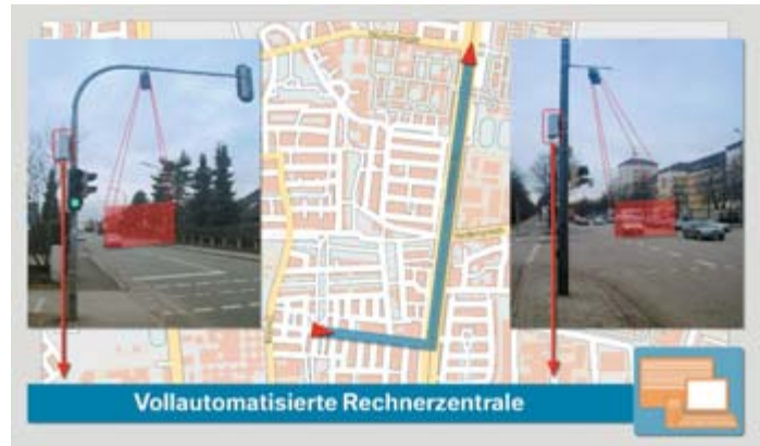
Bild 1: Systemarchitektur des Pilotsystems zur innerstädtischen Reisezeitmessung mit Fahrzeugwiedererkennung
