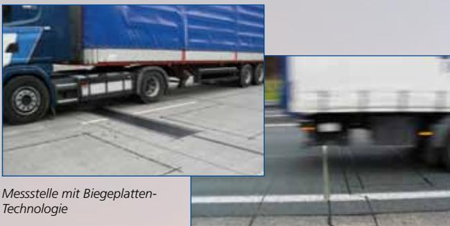
Messstelle mit Biegeplatten-Technologie
